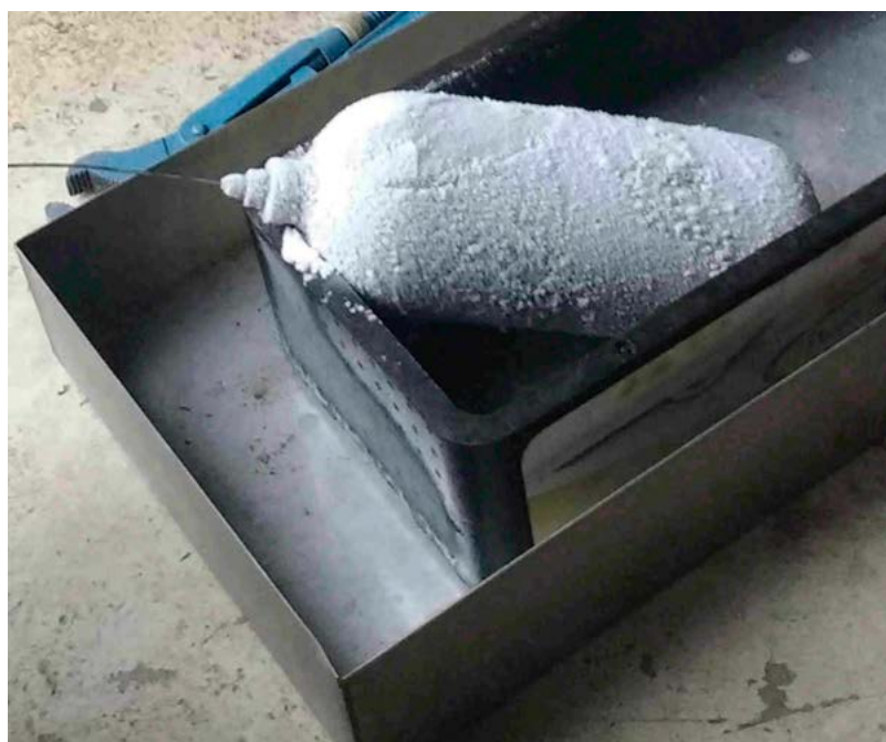
Abb. 1: Beprobung eines 10 MPa (100 Bar) Druckbehälters mit Flüssigkeitsfüllung nach Gefrieren in Flüssigstickstoff. Die Abmaße ähnelten dem Sarinbehälter von Bramsche. Behälter war ohne Kampfstoff.
