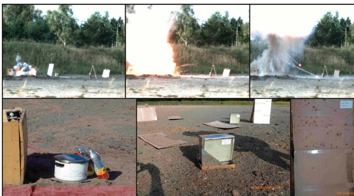
Abb. 4: USBV-Versuch mit Nicotinsimulanz. Obere Reihe Hochgeschwindigkeitsbilder der Umsetzung. Untere Reihe Aufbau der USBV, Zielfeldauschnitt mit Deutlechen, ball. Seife und Tröpfchensammlern, Tröpfchensammler zeigt Belegungsdichte mit Simulanz. Tröpfchenkontamination reichte bis 17 m vom Nullpunkt. Eigener Versuchsaufbau
