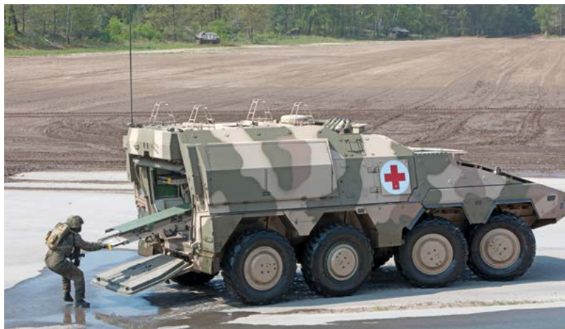
Abb. 4: Mit dem hoch mobilen sgSanKfz GTK Boxer BAT kann sowohl die rettungsmedizinische Erstversorgung als auch der Transport in eine Rettungseinrichtung erfolgen.
