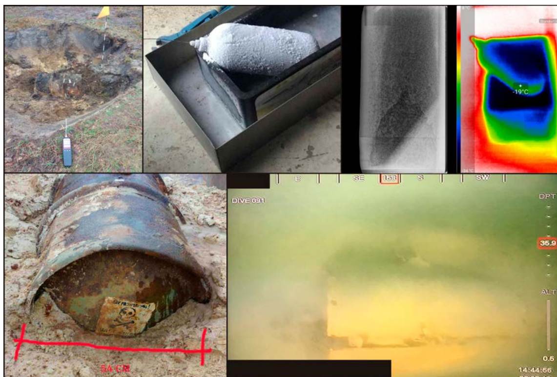
Abb. 6: Objekte mit Kampfstoffverdacht. Betriebsstoffbehälter mit PS-Verdacht auf TrÜbPl., Druckbehälter mit GB-Verdacht (Röntgen- u. Thermalbilder), Sowjetischer Kampfstofftransportbehälter mit GB-Verdacht, „SC-250“ unter Wasser, nach Ansprengung H/HD-Verdacht, Objekt war nicht als KC-250 erkennbar.
