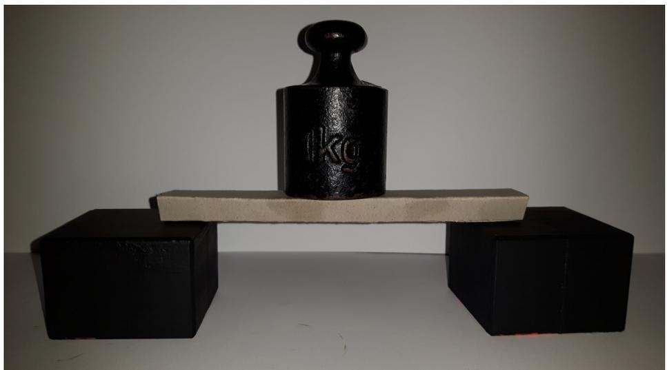
Je nachdem, wie man eine Brücke baut, hält sie besser oder schlechter, sie ist also mehr oder weniger stabil. Damit die Brücke unter schwerem Gewicht nicht zusammenbricht, ist es wichtig, dass sich das Gewicht gut auf die verschiedenen Teile der Brücke „verteilt“. Bei diesen Brücken ist dies der Fall, die Brücken sind stabil.
