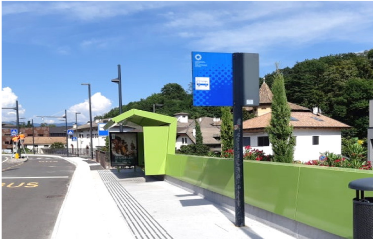
Bild A-7 Haltestelle mit taktilen Wegen Fig. A-7 Fermata con percorsi tattili
