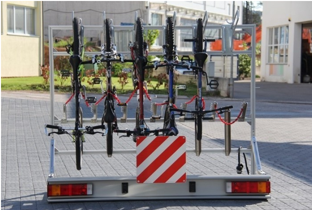
Abbildung 129 Systeme für den Transport von Fahrrädern für Busse [Quelle: Firma X-metal]
