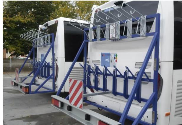
Abbildung 129 Systeme für den Transport von Fahrrädern für Busse [Quelle: Firma X-metal]
