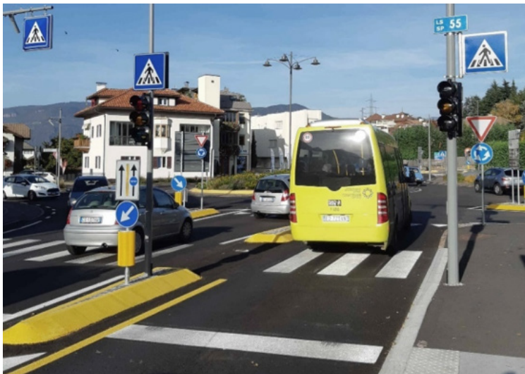
Bild B-16 Ampel für Bus-Vorfahrt Fig. B-16 Semaforo di precedenza bus
