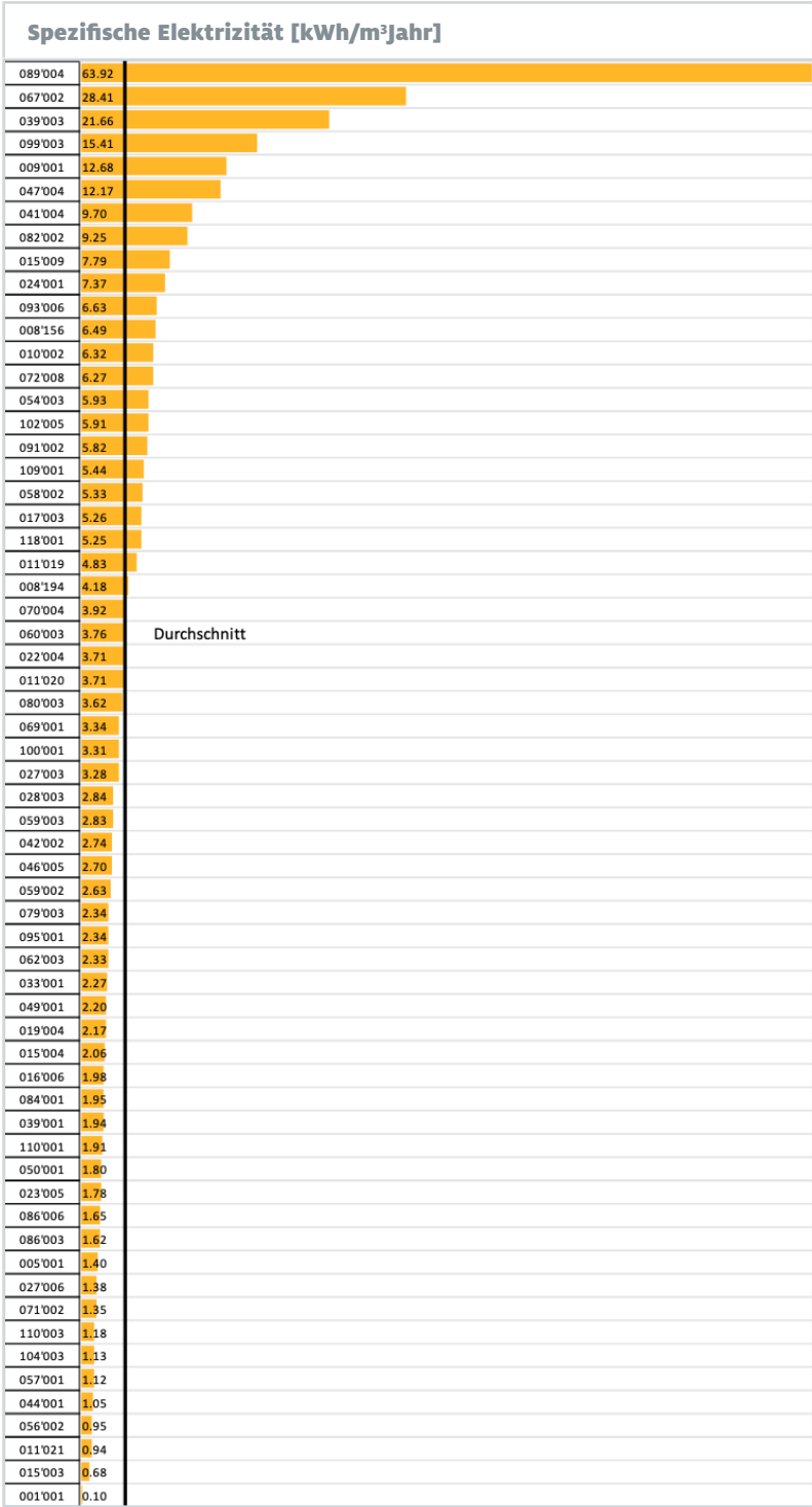
Abbildung 17: Mittlerer spezifischer Stromverbrauch der Straßenbauhöfe und Straßenstützpunkte der Autonomen Provinz Bozen, 2020–2024
