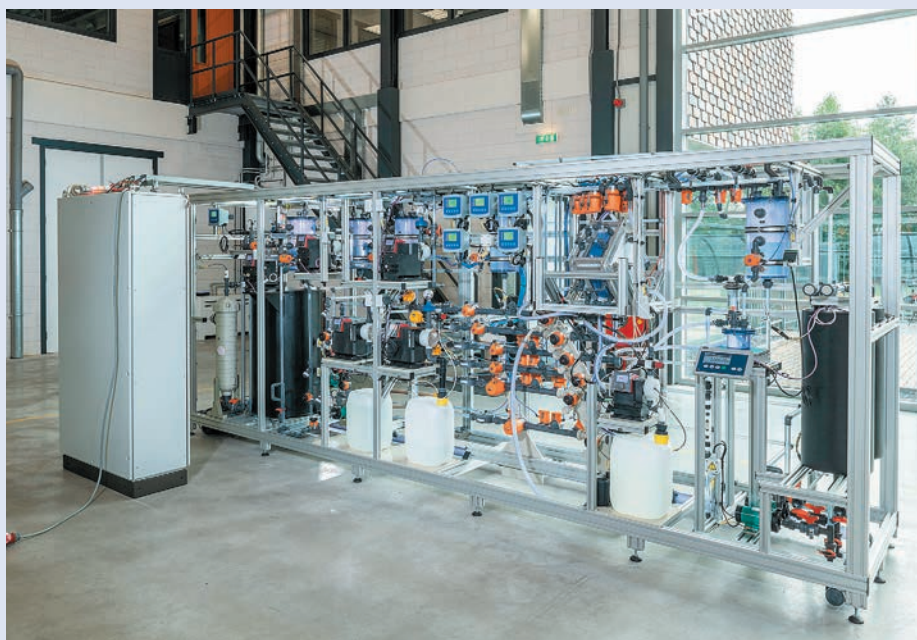
Chemicaliënvrije extractie van stikstof met de procesopstelling van Evides Industriewater, W&F Technologies, Wetsus en het Catalaanse waterinstituut ICRA
