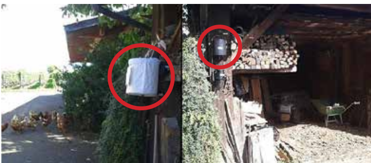
Falle des Typs BG-Sentinel (Bild links) und Falle des Typs CDC (Bild rechts)
