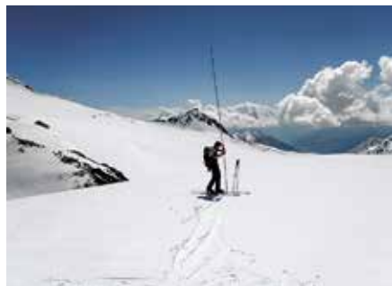
48 - Sondaggio per la misura dell'altezza del manto nevoso.
