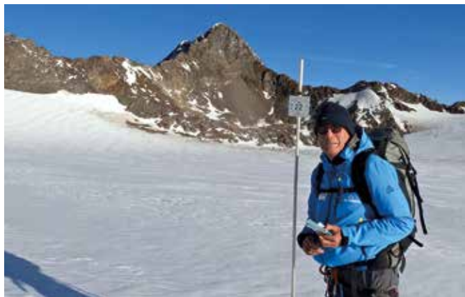
50. Lettura di una palina ablatometrica.
