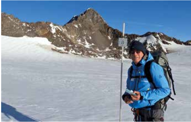
50. Ablesung eines Ablationspegels.
