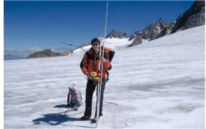
51. GPS-Vermessung der Position der Ablationspegel.
