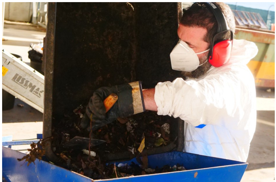
Sieben des Siebunterlaufs < 40 mm mit elektrischem Rüttelsieb
