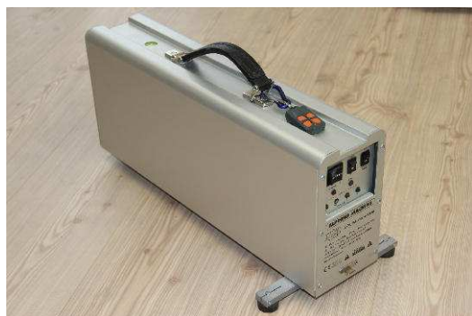
Fig. 25: Trittschallklopfer. Quelle: TBZ GmbH
