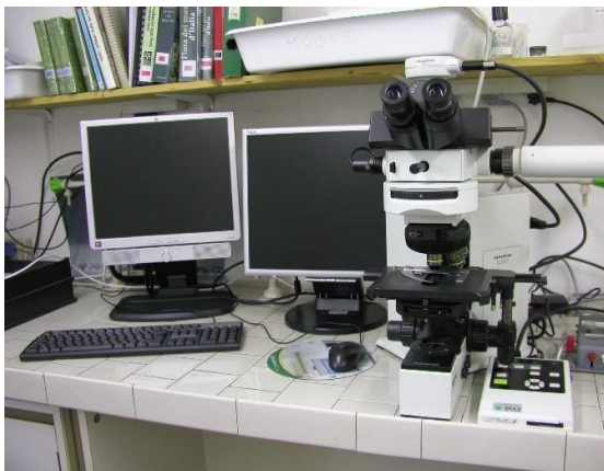
Foto 5: Valutazione dei campioni di diatomee in laboratorio mediante microscopio a luce trasmessa e computer (fonte: Agenzia per l'ambiente)
