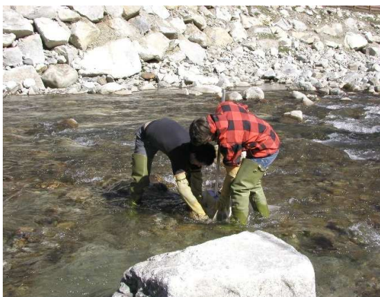
Foto 7: Il campionamento del macrozoobenthos si svolge con l'ausilio di uno speciale guadino in diversi spazi vitali parziali nella sezione del corso d'acqua (fonte: Agenzia per l'ambiente)
