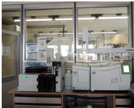
Foto 2: Gas Massa Clarus – analisi dei solventi clorurati (fonte: Agenzia per l’ambiente).
