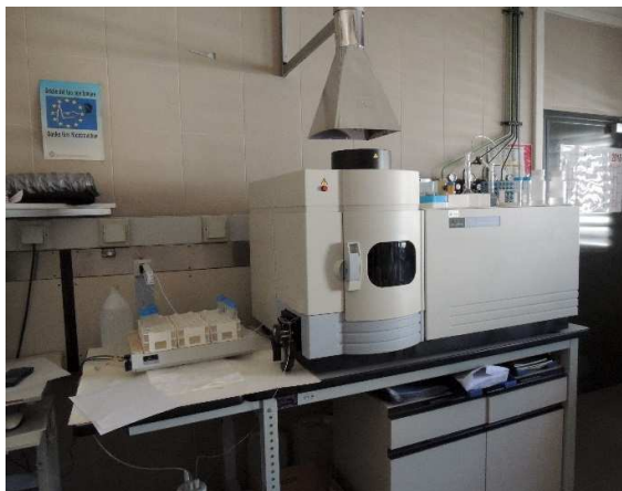
Foto 1: IPC Ottico Optimo – analisi dei metalli (fonte: Agenzia per l’ambiente).
