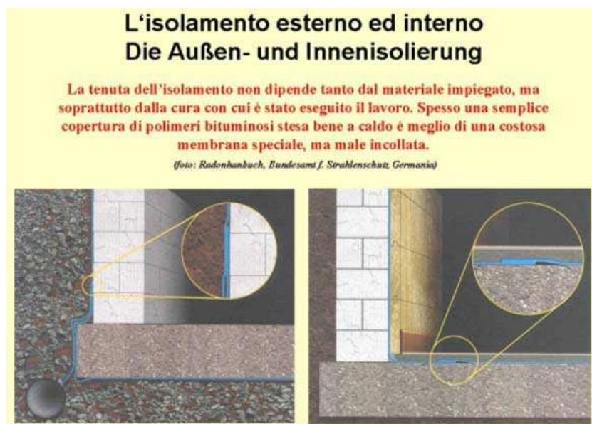
FIGURA 22) L'isolamento con membrane impermeabili.
