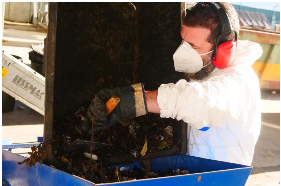
Sieben des Siebunterlaufs < 40 mm mit elektrischem Rüttelsieb
