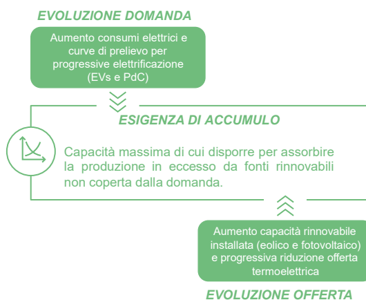
Figura 31. Flessibilità offerta da un sistema di accumulo.
