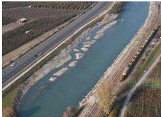
Abb. 35 Flussbettaufweitung en in der Ahr und in der Etsch
