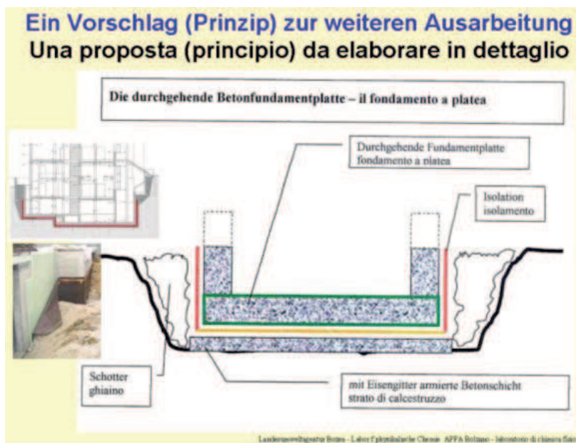
Abbildung 18) Die durchgehende Betonfundamentplatte
