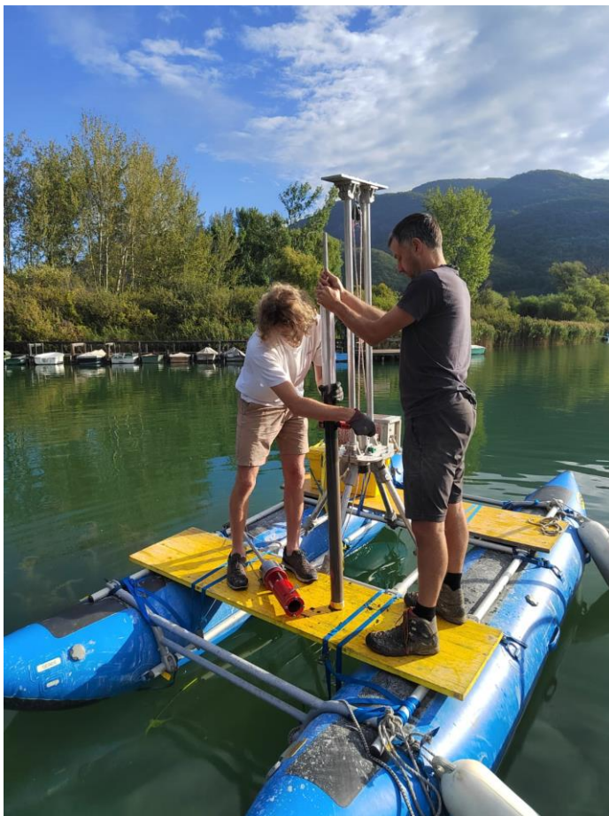
Abbildung 2: Links: Entnahme eines Hammer-Kerns. Rechts: UWITEC Oberflächen-Kerngerät (© 2023 UWITEC GmbH)
