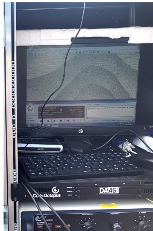
Abbildung 1: Aufbau für das Subbottom Profiling. Links: das CataRaft mit Pinger, welches am Fischerboot befestigt wurde. Rechts: Monitor, auf dem die Ergebnisse des Subbottom Profiling direkt angezeigt werden.
