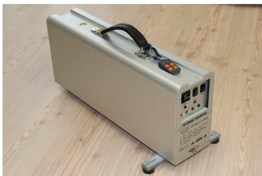
Fig. 24: generatore di calpestio. Fonte: TBZ S.r.l.
