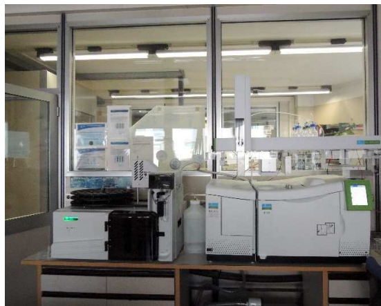
Foto 2: Gas Massa Clarus – Analyse chlorierter Lösungsmittel (Quelle: Umweltagentur).
