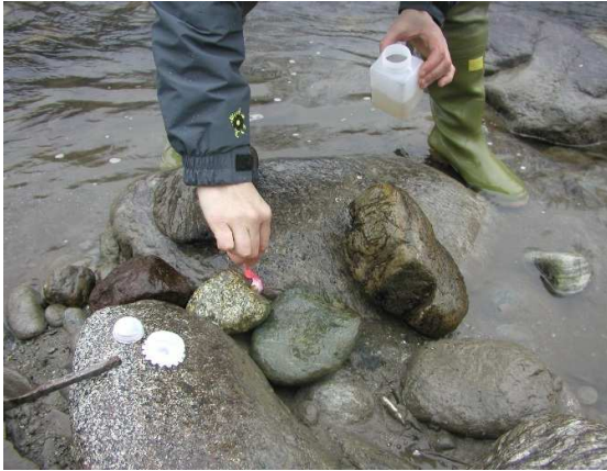
Foto 4: Beprobung der Kieselalgen durch Abreiben der Steinoberflächen mit einer Zahnbürste (Quelle: Umweltagentur).
