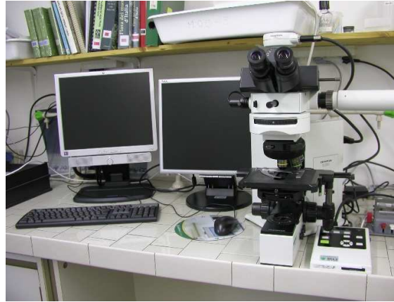
Foto 5: Die Auswertung der Kieselalgenproben im Labor erfolgt am Durchlichtmikroskop und am Computer (Quelle: Umweltagentur).
