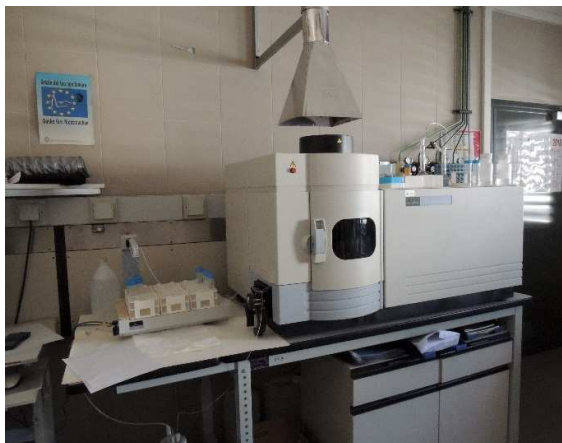
Foto 1: IPC Ottico Optimo - Analyse der Metalle (Quelle: Umweltagentur)
