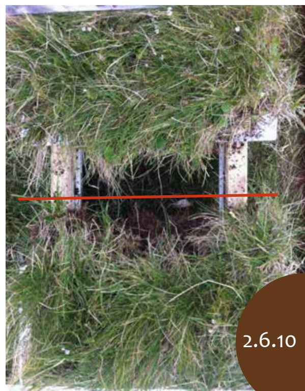
Abb.1: Bruchlinie während des Tests auf Zugfestigkeit (Abbildung aus Löbmann et al. 2020 a)
