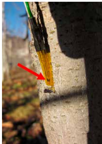
Abb. 1: Ein Temperatursensor vor (links) und nach dem Einführen (rechts) unter die Baumrinde. Der rote Pfeil kennzeichnet den genauen Messpunkt am Sensor.
