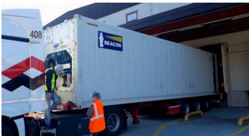
Überprüfung der Temperaturanzeige der Sonden vor dem Apfelexport nach Thailand
