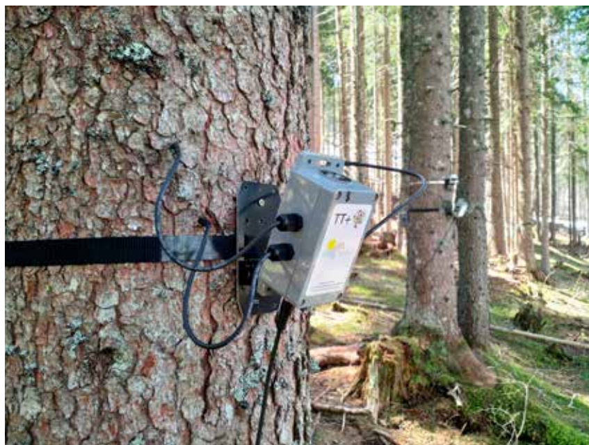
Abb. 1: Ein Baum der mit einem TreeTalker überwacht wird
