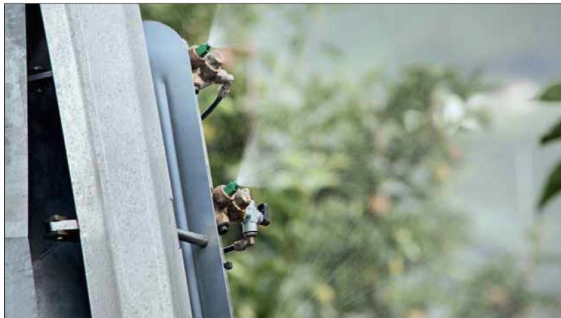
Nach dem Einsatz sollten Sprüher und Waschwasser richtig gereinigt werden.
