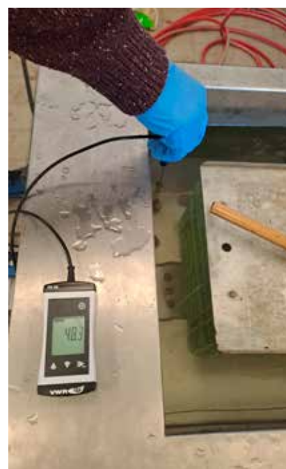
Abb. 3: Die Wassertemperatur im Heißwasserbad muss ständig überwacht werden.
