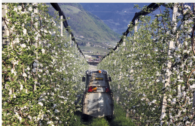
La nuvola di miscela è visibile stentamente se si utilizzano atomizzatori con ugelli antideriva.
