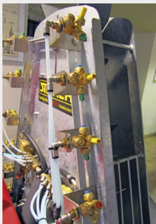
Torretta con ugelli a ventaglio antideriva sulle tre posizioni più alte della corona.
