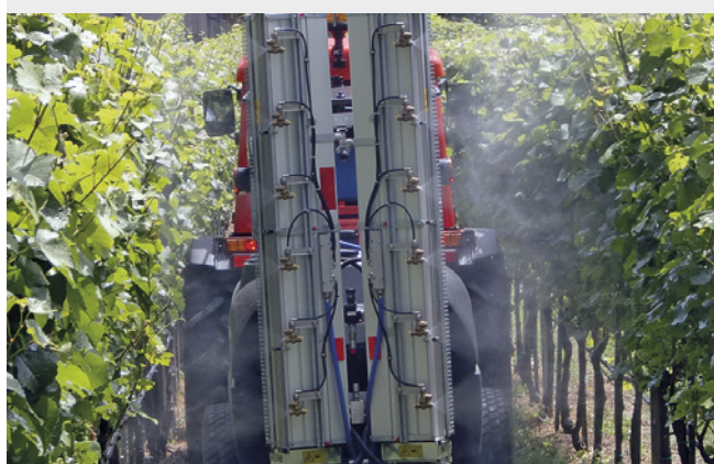
Impiego di ugelli a ventaglio antideriva in un impianto a spalliera.
