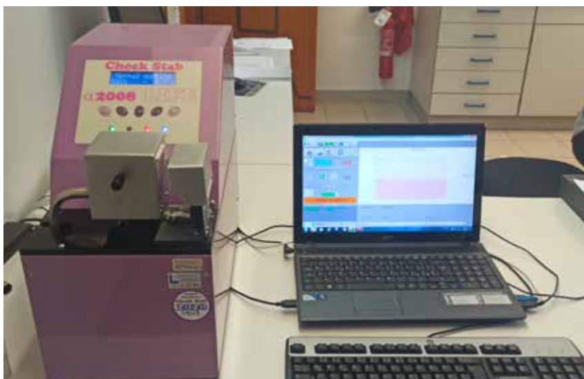
Fig. 4: Checkstab α2000 Life, strumento di laboratorio per misurare la variazione della conducibilità elettrica
