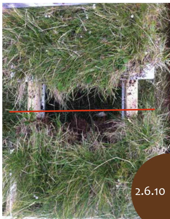
Fig.1: Linea di frattura durante la prova di resistenza alla trazione (Löbmann et al. 2020 a)
