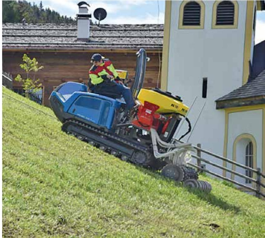
Abbildung 1. Schema des realisierten Prototyps der Rasensämaschine (Direktsaat/ sod-seeding) und während der Arbeitsphase auf einem 60%igen Hang, montiert auf einer Maschine der Geier srl, Marlenigo-BZ
