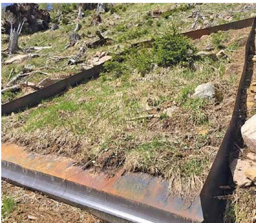
Abb. 1: Versuchsflächen zur Messung des Abflusses und der durch Erosion entstandenen Sedimente am Lavazè-Pass im Rahmen des Projekts MoniVa.
