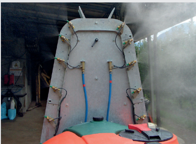
Flachstrahl-Injektordüsen (links) erzeugen keine sichtbare Sprühwolke, Hohlkegeldüsen (rechts) schon.
