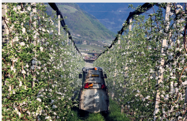
Der Sprühnebel ist bei Geräten mit Injektordüsen kaum mehr sichtbar.
