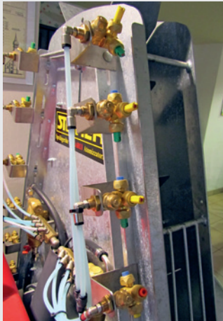
Gebläseaufbau mit Flachstrahl-Injektordüsen an den drei obersten Düsenpositionen.
