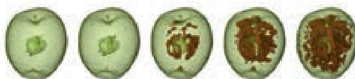
Fig. 2: Immagine CT tridimensionale di un danno interno durante la conservazione (KU Leuven)
