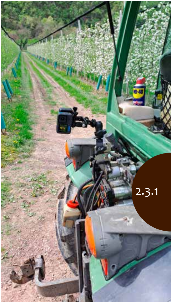
Videocamere montate su trattore, per la conta di fiori e frutti
