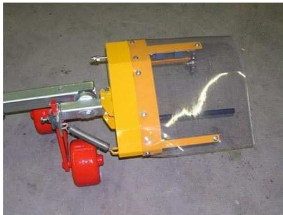
Figura 4: Irroratrice schermata per il diserbo localizzato del sottofila delle colture arboree
