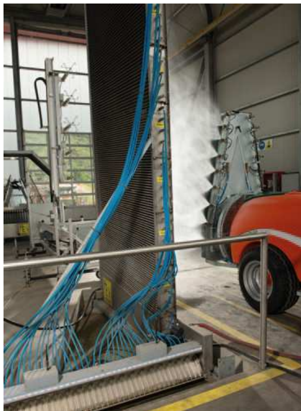
Figura 3: Irroratrice al banco prova
