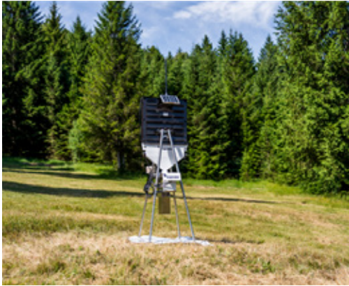
↑ Trappola automatica per il monitoraggio del bostrico
