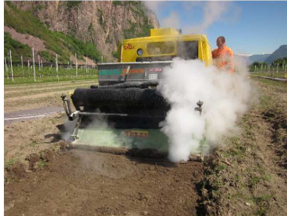
Sterilisieren des Bodens Ecostar SC600
