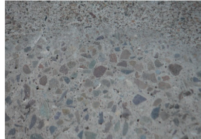
Abbildung 5: Beton mit grober Gesteinskörnung
