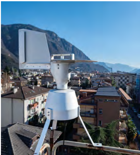
Pollenfalle am Dach der Landesagentur für Umwelt und Klimaschutz in Bozen: Wöchentlich wird die Pollentrommel ausgetauscht und im Biologischen Labor in Leifers ausgewertet.
