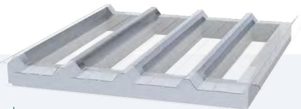
Le JI Isotrans Polycarb doit être mis en œuvre dans le même ordre que tout autre panneau, comme indiqué aux points 1, 2, 3. Le sens de pose doit être opposé à la direction du vent dominant pour éviter l'intrusion de l'eau de pluie le long du chevauchement. Le recouvrement latéral de l'autre côté et du démaillage doit être précisé lors de la commande.
