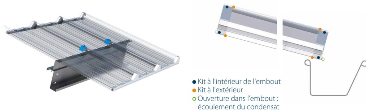
Les embouts peuvent être scellés avec le kit JI Thermoroof Polycarbonate. Le kit doit être appliqué avec précaution pour éviter qu'il ne se retrouve dans l'embout. Si l'embout est bouché, l'humidité ne peut pas être évacuée du JI Thermoroof !
