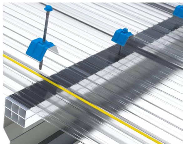
Chaque vis sur l'onde (tant la vis principale que la vis de recouvrement) doit être munie d'un cavalier. Cela consolide la fixation et réduit également le risque d'infiltration d'eau le long de la vis.
