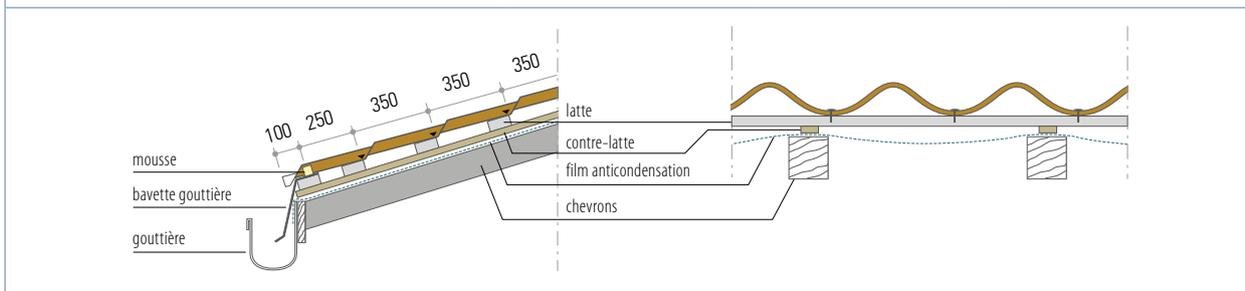
**Voliges et lattes** Sur la sous-structure, il faut d'abord monter des contre-lattes, sur lesquelles on posera des lattes à une distance de 350mm en partant du milieu d'une latte jusqu'au milieu de la suivante. Attention: sous la première série de tuiles du côté de la gouttière, on placera deux lattes, la latte inférieure étant 1cm plus épaisse que l'autre. Les lattes restantes seront fixées au bout de chaque tuile.
