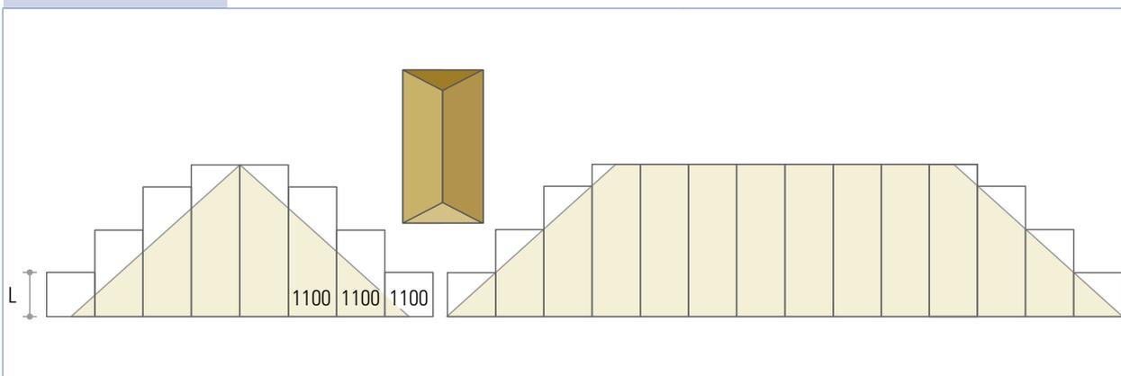
**Toiture à deux longueurs différentes dans un seul plan de toit**
