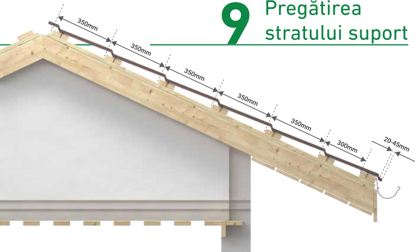
Învelitorile realizate din panouri metalice profilate tip țiglă metalică sunt profile portante și pot fi montate pe un suport realizat din panel de lemn sau metal (șipcă/contrașipcă). Suprafața de reazăm/contact va fi de minim 50mm. Începeți instalarea contrașipcilor de la porțiunea de streașină de la care începeți montarea panourilor. Se recomandă ca șipcile să se fixeze pe poziția căpriorilor, folosindu-se cuie sau holtsuruburi.
