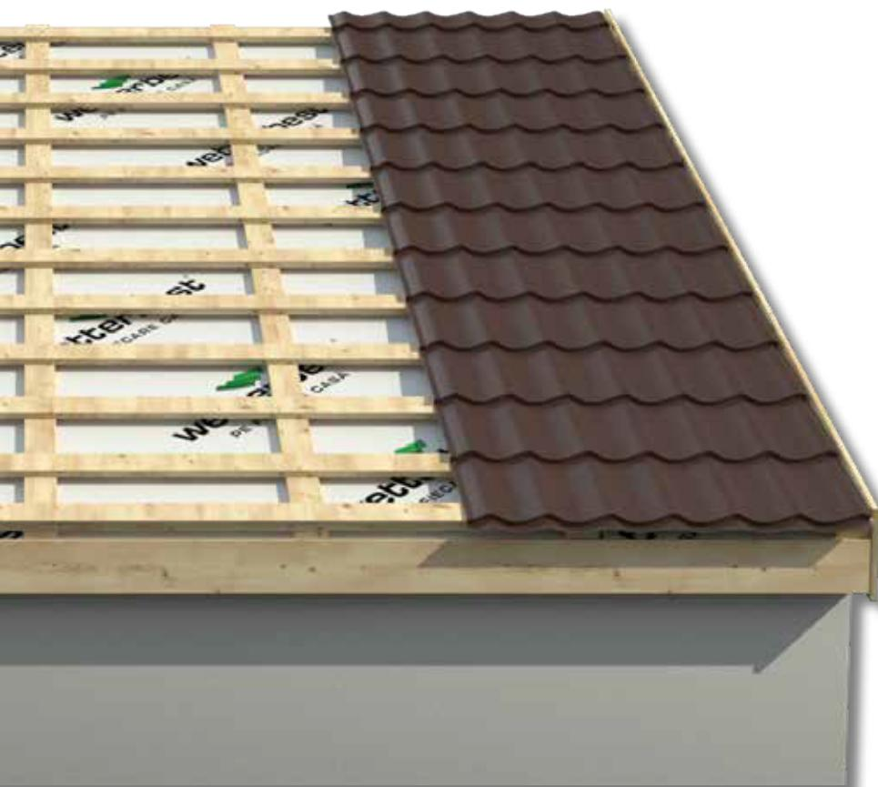
Instalarea de la stânga la dreapta este indicată în cazul șarpantelor înclinate sau cu panouri foarte lungi. Sub marginea din partea dreaptă a panoului deja fixat se va împinge sub el următorul panou care va fi susținut de către primul. În cazul pantelor dreptunghiulare sau pătrate, instalarea panourilor se face începând din apropierea frontonului sau paziei. În cazul șarpantelor oblice (coama înclinată) se va începe din zona de capăt a coamei.
