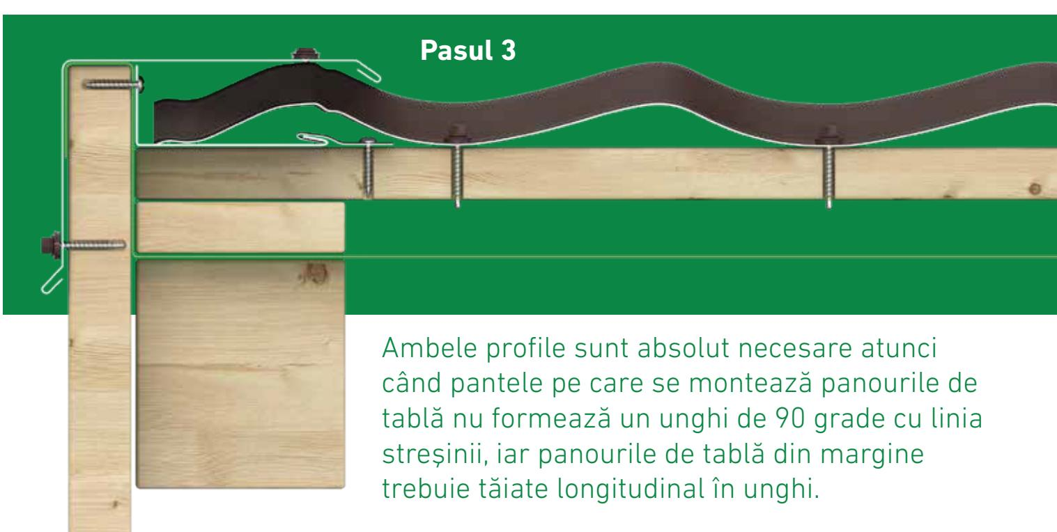
Ambele profile sunt absolut necesare atunci când pantele pe care se montează panourile de tablă nu formează un unghi de 90 grade cu linia streșinii, iar panourile de tablă din margine trebuie tăiate longitudinal în unghi.
