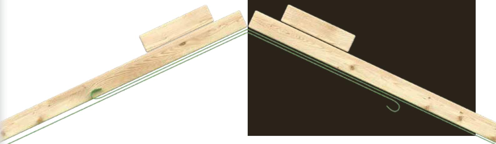
Ultima bucată de membrană trebuie pusă pe coamă acoperită cu o suprapunere de min. 15 cm, aşa încât coama să fie suprapusă de două ori.
