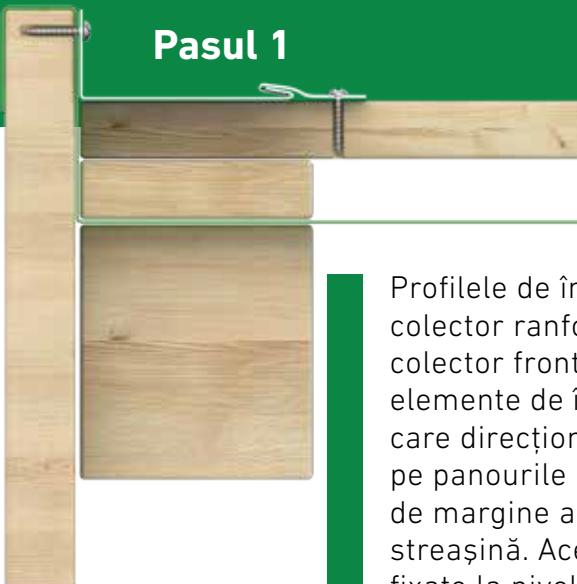
Profilele de închidere pazie colector ranforsată (1) și colector fronton (2) sunt elemente de închidere ascunse, care direcționează apă scursă pe panourile de țiglă din zona de margine a învelitorii către streașină. Aceste profile sunt fixate la nivelul panourilor de tablă direct pe șipcă, prin cleme și cu șurub cu cap flat de pazia de lemn, fixată anterior ca suport.
