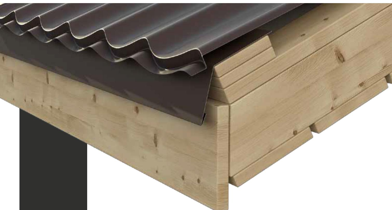
Șorțul streașină odată montat, reprezintă linia de referință la montajul învelitorilor metalice. Panourile de tablă sunt poziționate în funcție de linia de streașină. Asigurați-vă că profilele de streașină sunt aliniate și că panourile de tablă vor fi perpendiculare pe direcția streșinii. După acest pas, fixați șorțurile de streașină de prima șipcă cu șuruburi cu cap plat sau cu cuie galvanizate.
