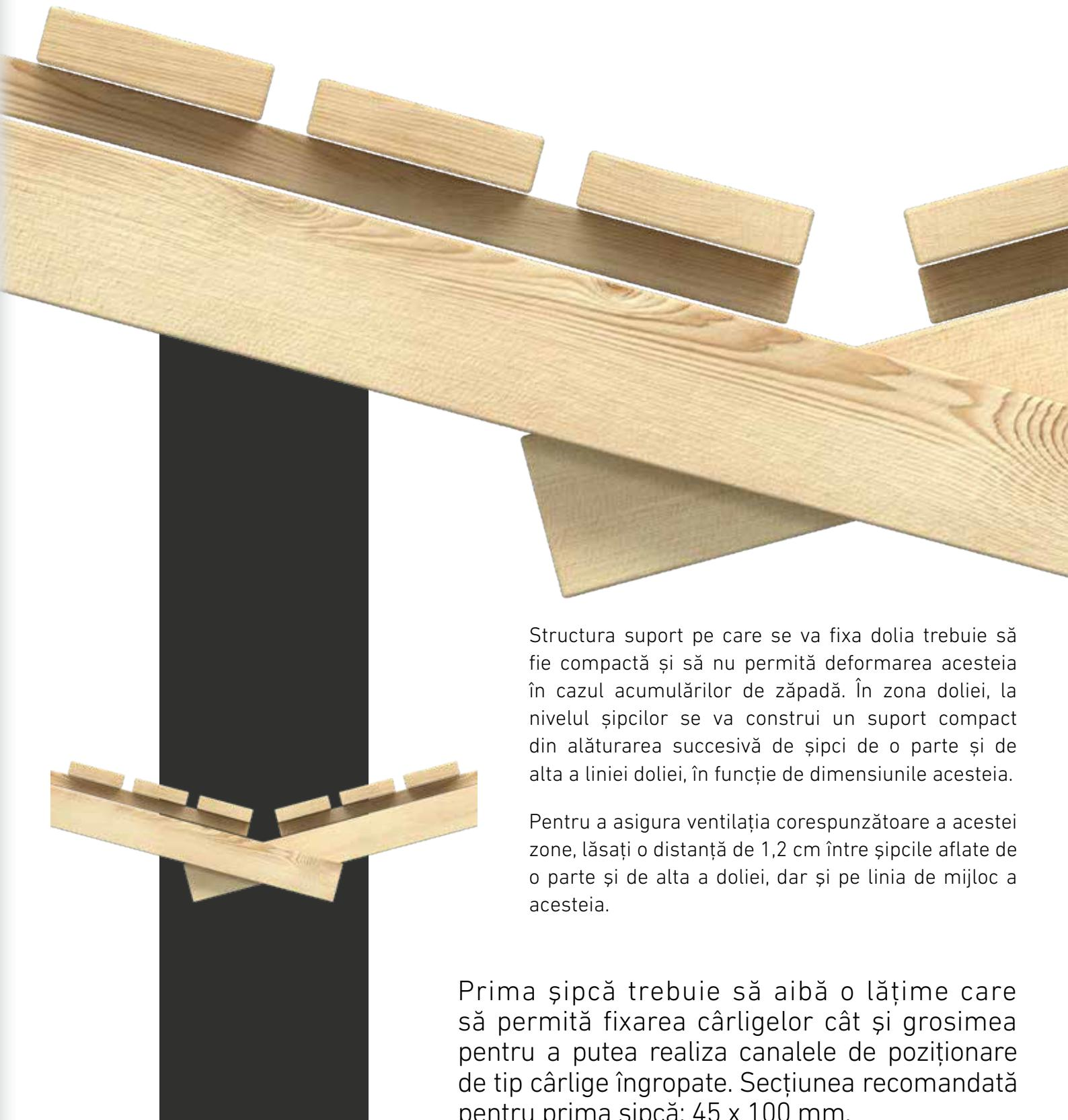
Structura suport pe care se va fixa dolia trebuie să fie compactă și să nu permită deformarea acestea în cazul acumulărilor de zăpadă. În zona doliei, la nivelul șipcilor se va construi un suport compact din alăturarea succesivă de șipci de o parte și de alta a liniei doliei, în funcție de dimensiunile acesta.
