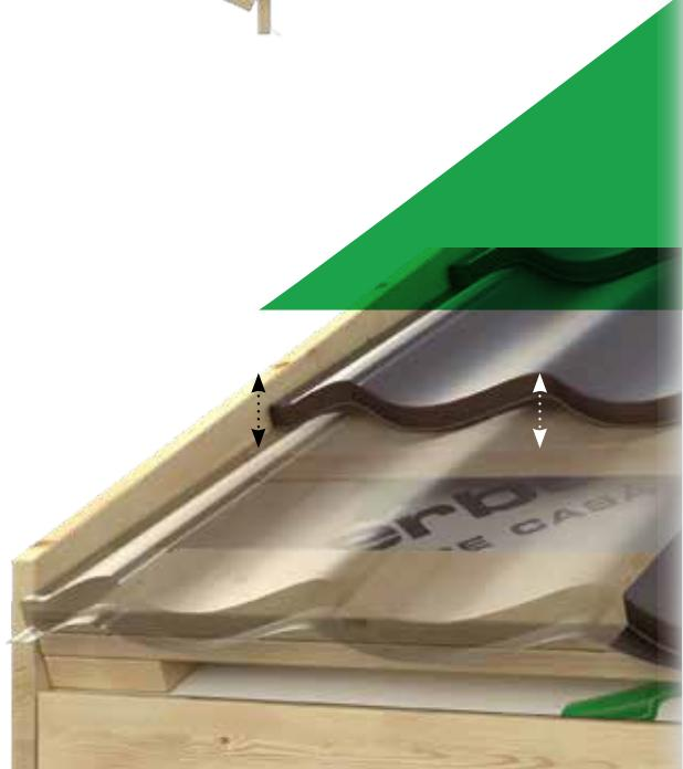
Panourile de țiglă se poziționează peste profilul de streașină și pot depăși 20 – 45 mm, în funcție de modelul ales. Pentru a poziționa corect pazia metalică, pazia de lemn se va fixa la nivelul panoului de tablă, astfel ca în funcție de modelul ales, distanța de la șipcă la extremitatea paziei de lemn se recomandă să fie:
