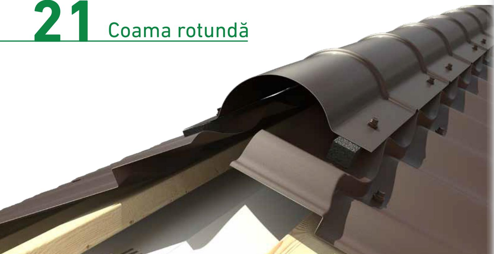
Pentru a se fixa coama de panourile de tablă se vor folosi șuruburi de coasere 4,8 x 20mm în dreptul fiecărui ondul. Înainte de a fixa coama pentru etanșare se vor utiliza bureți de etanșare sau banda de ventilație.
