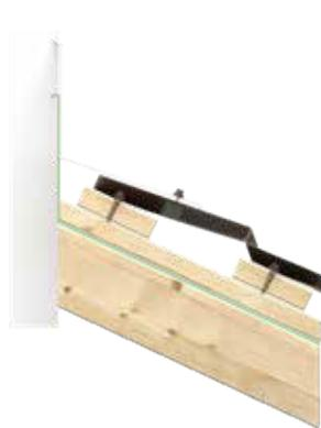
Pentru învelitorile în care întâlnim "racord calcan" lateral recomandăm utilizarea profilului colector care se va monta la nivelul caroiajului (șipcă) și sub panoul de tablă.
