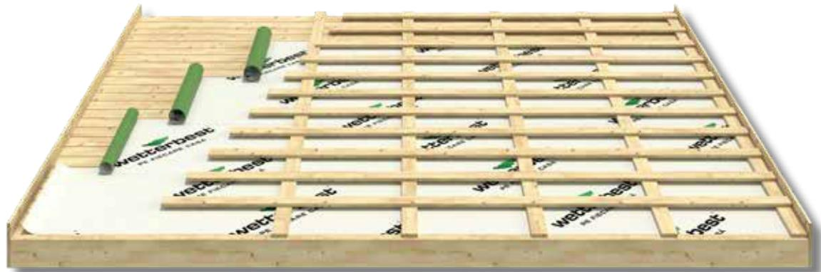
Membrana pentru acoperiș se folosește pentru etanșarea acoperișurilor cu pantă împotriva infiltrațiilor și pentru reducerea condensului ce se formează sub învelitoare. Cel mai eficient mod de montare a membranei este, începând de la streașină, în benzi paralele cu suprapunerile, suprapunerile a căror mărime este condiționată de unghiul de înclinare a acoperișului. A se urmări limitele marcate pe membrană.
