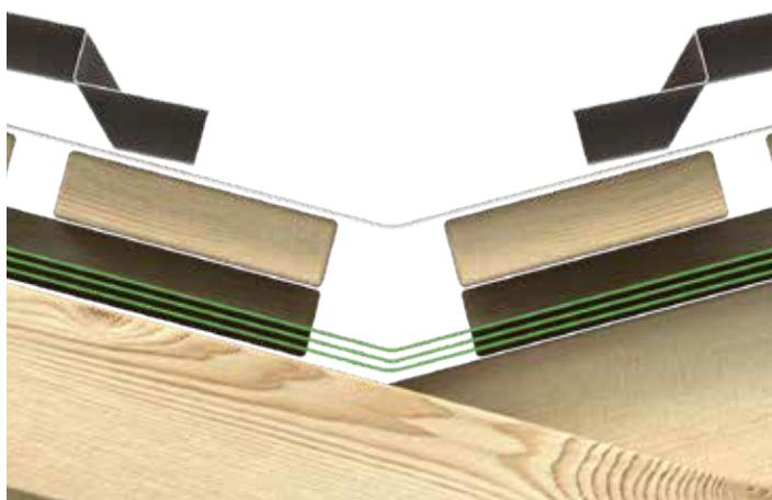
Panoul de dolie se fixează de patul de șipci cu ajutorul unor cleme realizate din tablă pe șantier. Nu recomandăm perforarea cu șuruburi a acestui element. Recomandăm ca lungimea minimă de suprapunere a doliilor să fie de 200mm. Partea inferioară a doliei ce se găsește în zona de streașină trebuie tăiată astfel încât să depășească linia de streașină 30mm și apoi să fie îndoită în jos paralel cu aceasta.
