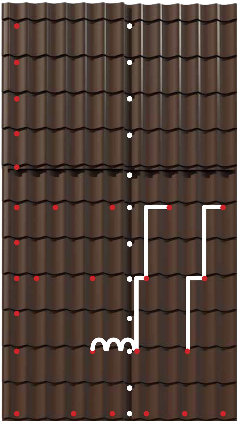
Ținând seama de forțele ce acționează asupra învelitorii (încărcare la vânt și zăpadă) cât și mișcările termice ale panourilor în sezonul cald/rece aceasta trebuie fixată de suport pentru a preveni desprinderea sau apariția infiltrărilor. Panourile de tablă se vor fixa de suport cu șuruburi de fixare 4,8 x 35mm în zona de streașină și coamă la fiecare două ondule ale panoului. În zona de fronton, panoul se va fixa la fiecare modul cu câte un șurub de fixare de la streașină până la coamă.
