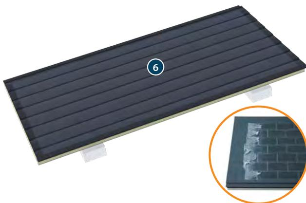
Bevor das JI Slate 1000VB PIR Panel **6** aufgenommen wird, wird die Kunststoffschutzfolie 5 cm rund um den Tafelrand gelöst. Dadurch wird vermieden, dass die Folie nach der Montage nicht vollständig entfernt werden kann.
