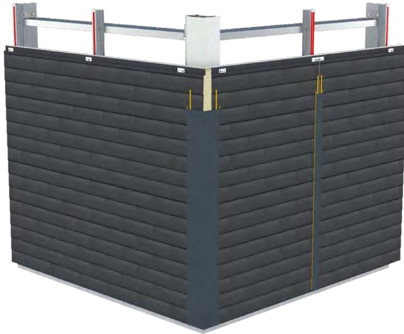
Dadurch eignet sich dieses Produkt perfekt für sowohl Neubauprojekte als auch Renovierungen! Im Folgenden wird die Montage an einer Stahlstruktur gezeigt. Durch die Verwendung von Omega-Profilen ist die Montageweise bei allen Strukturen gleich.
