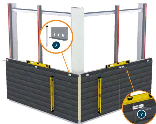
Die vertikale und horizontale Position wird kontrolliert und die Tafel wird anschließend mit Lastverteilerplatte und Metallschrauben **7** befestigt.
