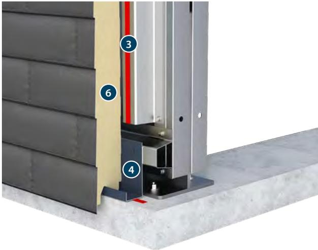
JI Slate 1000VB PIR **6** wird ins Startprofil **4** abgestellt und horizontal an Ort und Stelle geschoben.
