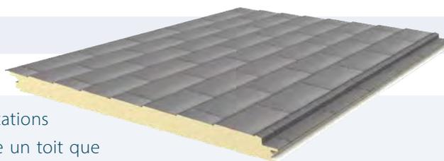
Jl Ardoise 1000FC PIR est un panneau isolé avec fixations cachées. Ce panneau peut être utilisé aussi bien comme un toit que comme un mur. Le panneau sandwich se compose d'une tôle d'acier extérieure à motif ardoise, d'une âme en mousse de polyisocyanurate (PIR) sans composés CFC-HCFC nocifs et d'une tôle d'acier intérieure légèrement profilée. En bref, la solution totale pour vos projets dans les secteurs tertiaire et résidentiel avec une finition de haute qualité.
