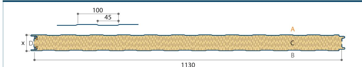
JI VULCASTEEL WALL M 1130 MICRO-NERVURÉ (OPTIONNEL)
