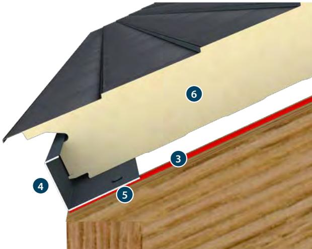
Le premier panneau JI Ardoise 1000FC PIR (6) peut ensuite être installé horizontalement. Notez que le profil de départ (4) offre également immédiatement la finition de bord de toit.
