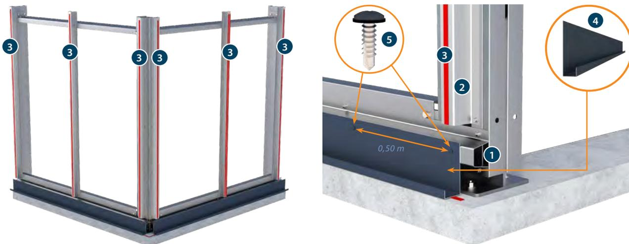
Après montage des omegas verticaux **2**, le JI Sealant **3** est apposé. Cela garantit une fermeture étanche à la vapeur entre la structure et le panneau et cela réduit les bruits d'impact. Le profil de départ **4** peut ensuite être fixé. La fixation est réalisée tous les 0,50 m à l'aide de vis torx (4,8 x 35 mm) **5**. Grâce à l'omega, le profil de départ reste bien droit, ce qui facilite le glissement du panneau.
