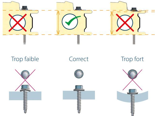
Attention ! Lors du vissage du panneau, la géométrie du panneau ne doit pas être modifiée ! La vis avec plaquette de répartition doit donc être vissée contre le panneau sans déformer ce dernier ! Si elle est serrée trop fort, le joint ne s'emboîtera plus !
