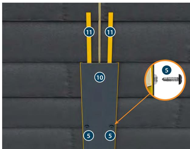
Deux lignes sont apposées avec JI Slate Kit **11** et le profil-T **10** est placé. Le profil-T est ensuite fixé chaque mètre avec deux vis torx **5** et à l'endroit indiqué **a**. Le joint doit colmater avec du JI Slate Kit.
