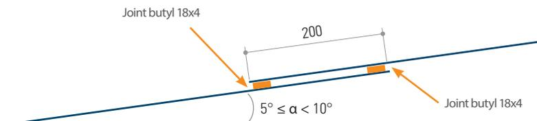
A partir de 10°, on utilise un recouvrement de 200 mm avec un joint butyl (18x4) à l'extrémité de la tôle supérieure.
