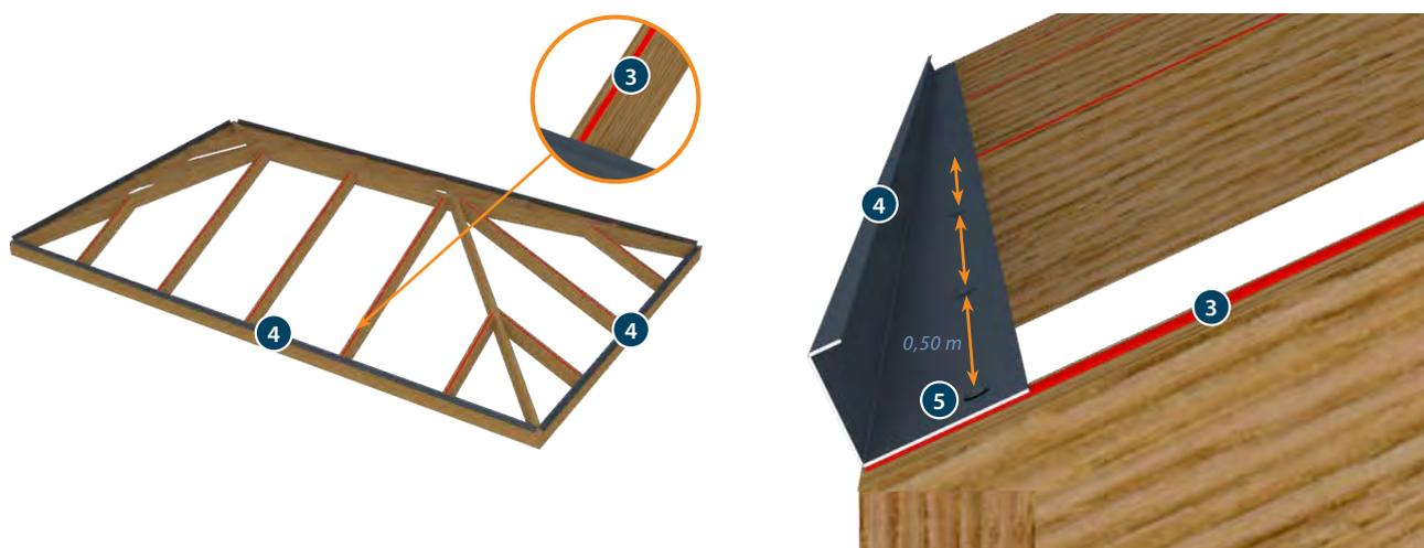
Une fois la structure de chevrons installée, le Jl Sealant **3** est installé entre les pannes et le panneau. Cela permet de réduire les bruits d'impact. Le profil de départ **4** est ensuite placé et vissé tous les 0,50 m à l'aide de vis torx **5**.
