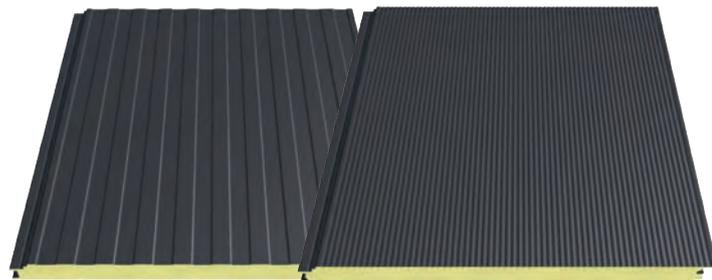
Au montage de ces panneaux (à partir d'une épaisseur de 80 mm) avec fixation cachée, il est impératif d'utiliser une plaquette de répartition en inox pour la solidité, ainsi que le panneau ne se déforme pas. Le nombre est en fonction des portées, des charges et de la qualité des matériaux de fixation.
