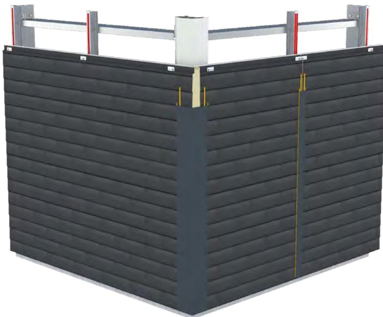
Cela rend ce produit parfaitement adapté tant pour les nouveaux projets de construction que pour les rénovations ! Le montage sur une structure en acier est illustré ci-après. Grâce à l'utilisation de profils-omega, la méthode d'assemblage est la même pour toutes les structures.
