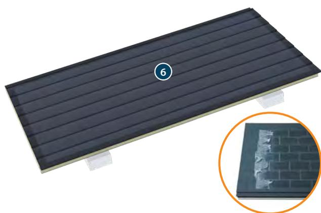
Avant de monter le panneau JI Ardoise 1000FC PIR **6** le film de protection en plastique doit être détaché de 5 cm tout autour du bord du panneau. Cela permet d'éviter que le film ne puisse être enlevé entièrement après le montage.
