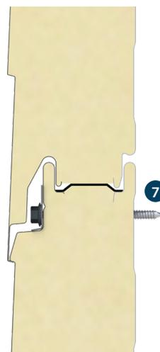
Après l'alignement du panneau supérieur, celui-ci peut être appuyé pour fermer la fixation cachée. Suit alors le vissage du panneau à l'aide de la plaquette de répartition et les vis métalliques 7.
