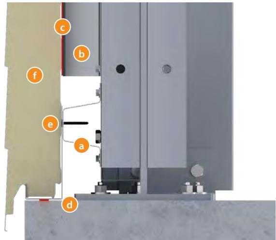
JI Ardoise 1000FC PIR **6** est déposé dans le profil de départ **4** et est poussé en place horizontalement
