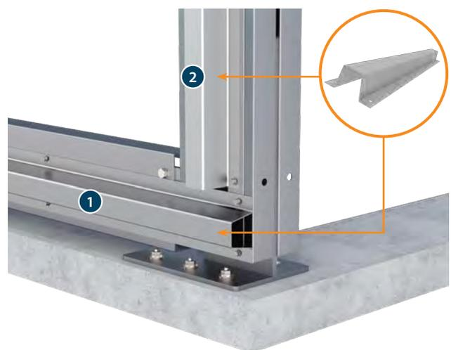
La première étape comprend l'installation des profils-omega de Joris Ide. Ils constituent la base de la structure arrière plate contre laquelle les panneaux doivent être montés et ils doivent donc être placés avec soin. Tout d'abord, le profil-omega horizontal ① inférieur est fixé et ensuite les profils-omega verticaux ②. L'espacement entre les profils verticaux est de maximum 1,50 m.
