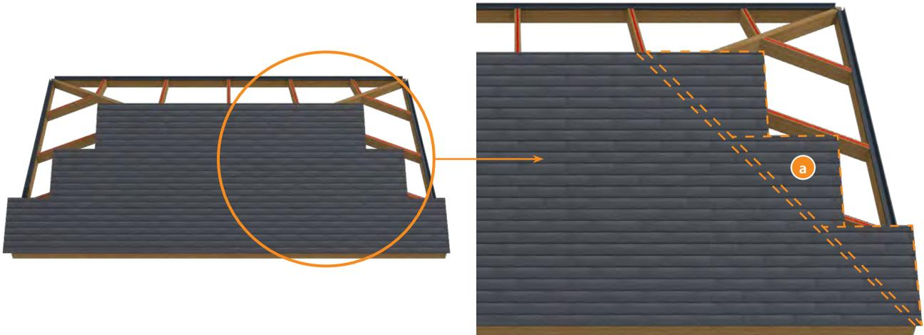
Les longueurs de panneaux complètes sont placées une à une sur le toit.
