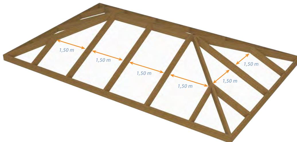
Le montage de la Jl Ardoise 1000FC PIR comme toiture est semblable à l'application de bardage. L'espacement maximal entre les supports verticaux est de 1,50 m. La pente de toit minimale est de 25° (ou 46,6 cm/m).
