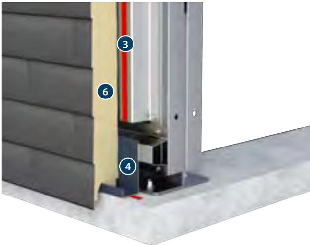
JI FC Ardoise 1000 (6) est déposé dans le profil de départ (4) et est poussé en place horizontalement
