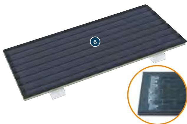
Avant de monter le panneau JI FC Ardoise 1000 ⑥ le film de protection en plastique doit être détaché de 5 cm tout autour du bord du panneau. Cela permet d'éviter que le film ne puisse être enlevé entièrement après le montage.
