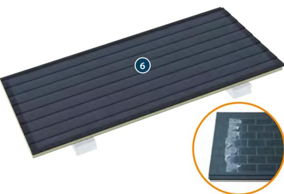
Avant de monter le panneau JI Ardoise 1000FC PIR ⑥ le film de protection en plastique doit être détaché de 5 cm tout autour du bord du panneau. Cela permet d'éviter que le film ne puisse être enlevé entièrement après le montage.
