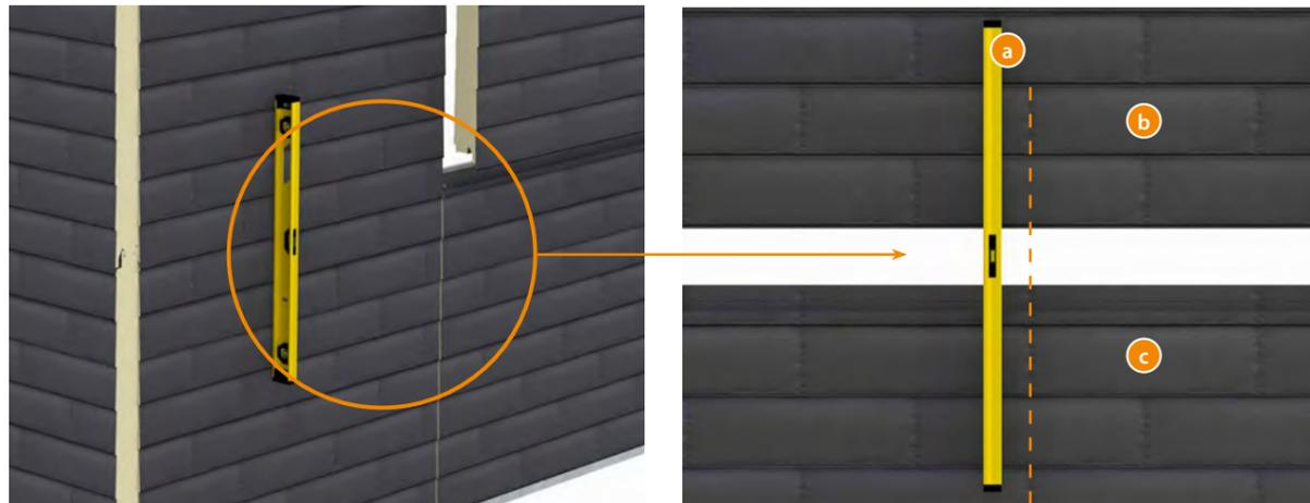
Il est important ici, avant que les panneaux ne soient effectivement emboîtés les uns dans les autres, qu'il soit contrôlé si le joint entre les ardoises est bien placé.
