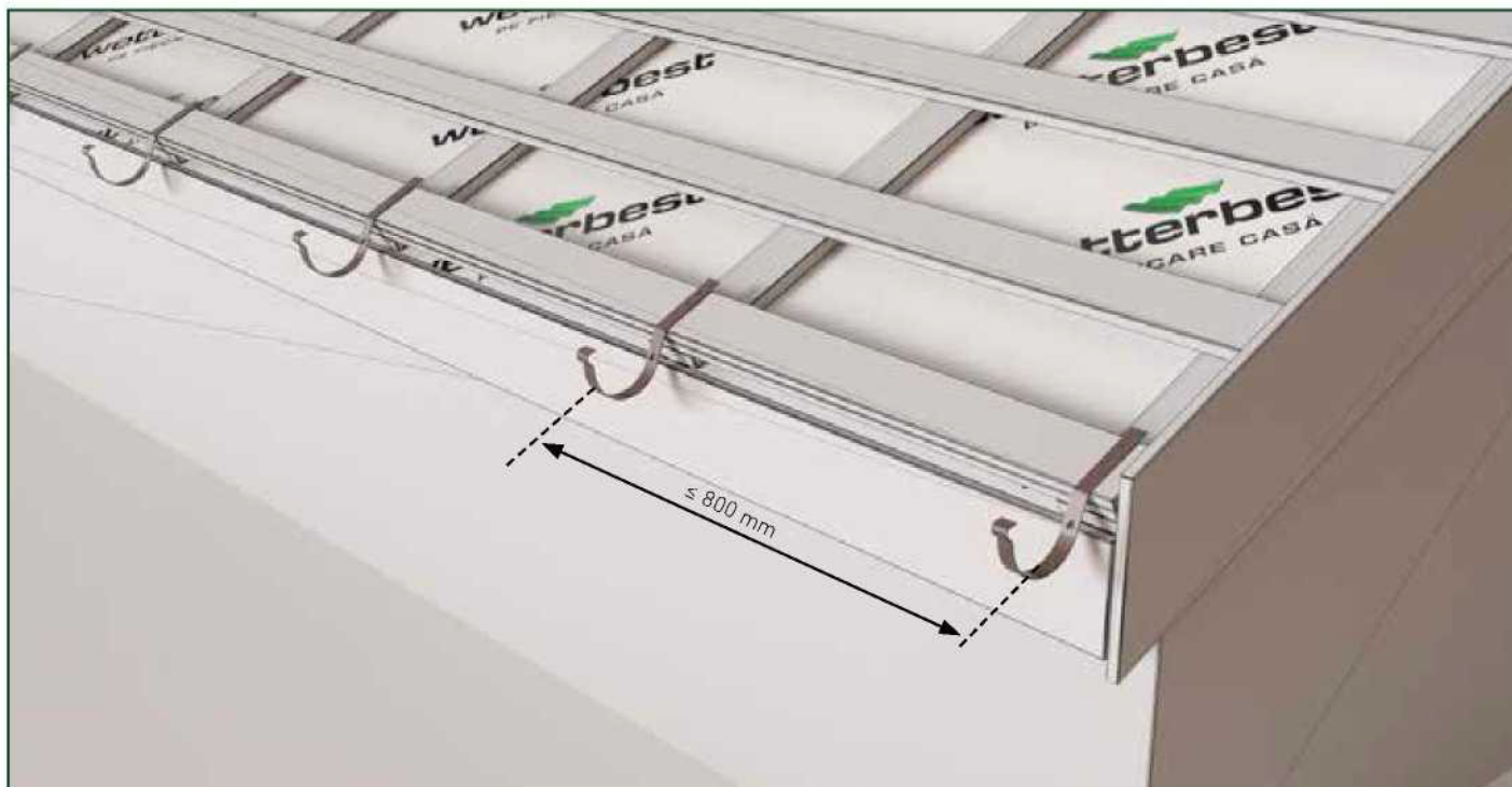
Az ereszcatorna kampók felszerelése
