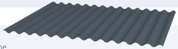
Das Sinus Wellblech JID 18-76-1064 ist aus feuerverzinktem Stahl gefertigt. Es zeichnet sich durch seine hohe mechanische Stabilität bei zugleich geringem Gewicht aus. Mit einer Höhe von 18 mm und einem Wellenabstand von 76 mm eignen sich die Profilbleche hervorragend für Fassaden- und Dachverkleidungen. Das gewellte Blech ist in vielen Längen und in einer Vielzahl von Materialstärken verfügbar.
