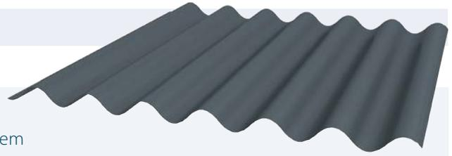
Wellbleche gehören zu den bekanntesten Profilblechen. Das Sinus Wellblech Jl 46-150-900 ist aus feuerverzinktem Stahl gefertigt und zeichnet sich durch seine hohe mechanische Stabilität bei zugleich hoher Tragfähigkeit aus. Mit einer Höhe von 46 mm und einem Wellenabstand von 150 mm eignet sich das Wellblech hervorragend für Fassaden- und Dachverkleidungen. Das gewellte Blech ist in vielen Längen und Materialstärken verfügbar.
