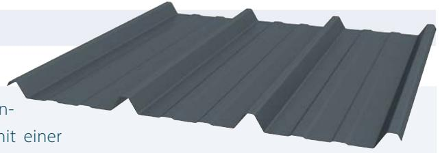
Das Trapezblech Jl 45-333-1000 dient der Leichtdacheindeckung mit feuerverzinktem Stahl. Das Außenblech mit einer Höhe von 45 mm und einem Sickenabstand von 333,3 mm kann mit dem Isolierpaneel JID Roof PIR kombiniert werden. Das Trapezblech ist in vielen Längen und Materialstärken erhältlich. Wir beraten Sie gerne dazu, mit welcher Stärke Sie die von Ihnen benötigte Tragfähigkeit gewährleisten.
