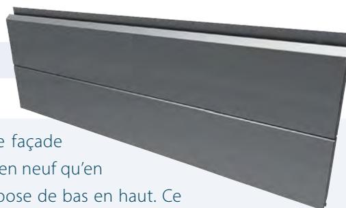
La lame JI Grégale bordée rainurée est un système d'habillage de façade rapportée, d'aspect plan, à fixations cachées. Elle s'utilise aussi bien en neuf qu'en rénovation. Cette lame bordée et rainurée ('effet trompe l'œil') se pose de bas en haut. Ce produit nécessite un support réglé ou une ossature réglable.
