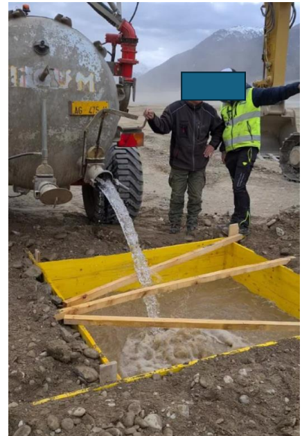
Abbildung 14, Durchlässigkeitsversuch ( \varnothing = 1,0 m, Höhe = ca. 1,0 m); Links: Versetzen des Versuchsschachtes; Mitte: Wassersättigung des Bereichs um die Versuchsdurchführung; Rechts: Messeinrichtung zum Ablesen des Wasserstandes
