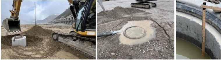
Abbildung 14, Durchlässigkeitsversuch ( \varnothing = 1,0 m, Höhe = ca. 1,0 m); Links: Versetzen des Versuchsschachtes; Mitte: Wassersättigung des Bereichs um die Versuchsdurchführung; Rechts: Messeinrichtung zum Ablesen des Wasserstandes
