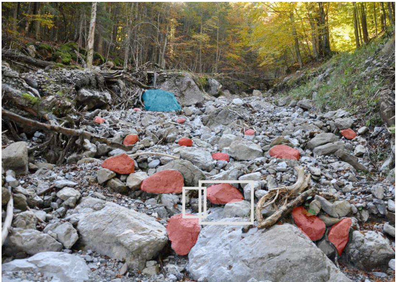
Abbildung 12. Beispiel für eine Schuttablagerung in einem Flussbett, die überwiegend aus Kalkstein besteht. Die modale Größe der groben Fraktion (> 6 cm auf der Medianachse) ist rot hervorgehoben, während der blaue Block als der größte Block identifiziert wird, mit Ausnahme der Ausreißer.
